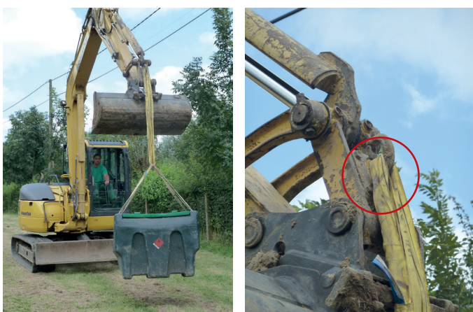
Foto: ophangpunt voor het hijsen met de graafmachine - © Inverde
